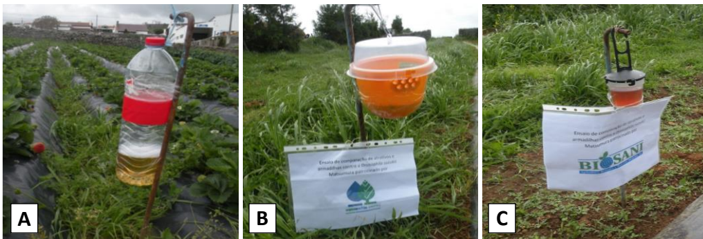
Figura 1 – Armadilhas estudadas: A – Armadilha artesanal com 300 ml vinagre de vinho branco e 10 g açúcar; B - Drosal@pro com 200 ml de atrativo Drosalure@; C - Hemitrap@ com 300 ml de atrativo Suzii@.
